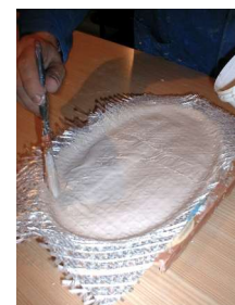
Terminar con una capa de Acrystal Prima
