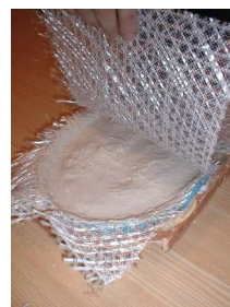
Colocar la segunda capa de fibra 200-4D
